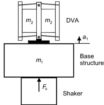
**Fig. 4:** Schema of test rig
