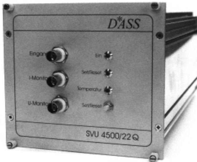
Bild 29: Vorderansicht des Verstärkers
